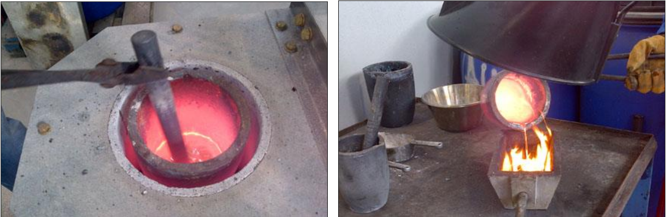
Figure 20 : Prise de vue photographique de l'opération de fusion et coulage en lingotière
